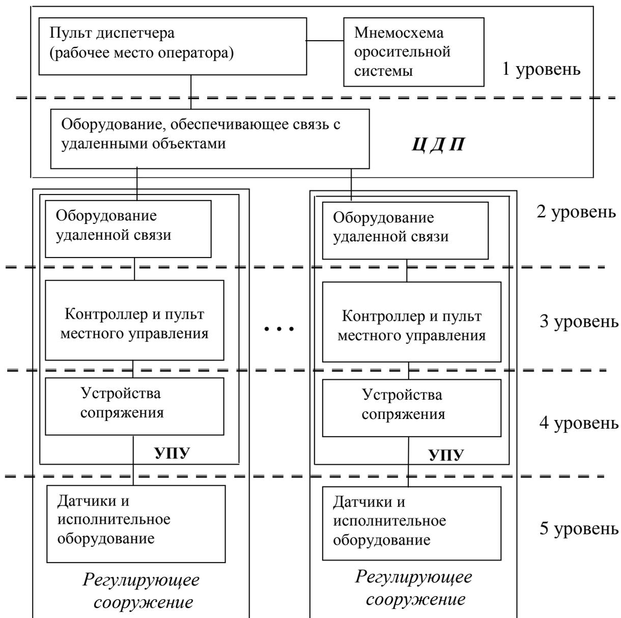
**Рисунок 1 – Структура аппаратных средств комплекса АСУ РГТС**
