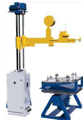
3. Электродуговая наплавка уплотнительных поверхностей деталей затвора арматуры
