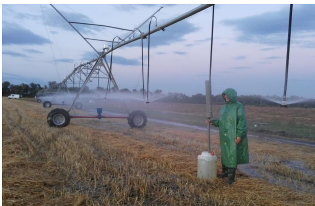
Определение расхода воды ДМ «Волга-ФК1» (испытания)
