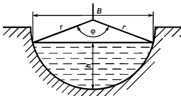
$B$  — ширина поверху;  $h$  — глубина воды в канале;  $r$  — радиус живого сечения;  $\varphi$  — центральный угол сечения
