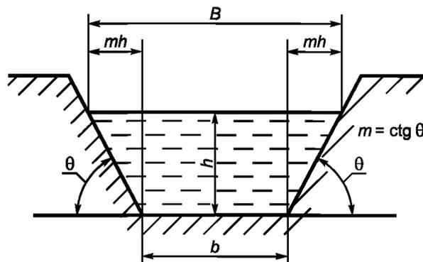
$B$  — ширина поверху;  $b$  — ширина канала по дну;  $h$  — глубина воды в канале;
