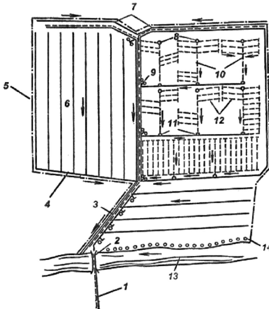
1 - дорожная сеть; 2 - мост; 3 - магистральный канал; 4 - транспортирующий собиратель; 5 - граница; 6 - открытая регулирующая сеть; 7 - оградительная сеть; 8 - смотровые колодцы; 9 - трубы-переезды; 10 - закрытые коллекторы; 11 - устьевые сооружения; 12 - закрытая регулирующая сеть; 13 - водоприемник; 14 - лесополоса
