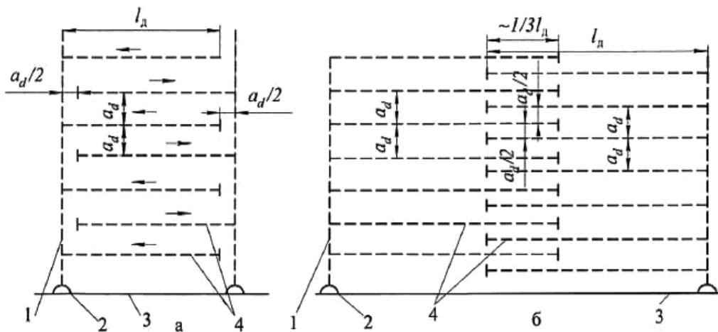
*а* - поочередное подключение дрен к соседним коллекторам; *б* - ступенное расположение истоковых участков дрен; 1 - закрытый коллектор; 2 - устье коллектора; 3 - проводящий (магистральный) осушительный канал; 4 - закрытые дрены;  $a_d$  - расстояние между дренами;  $l_d$  - длина дрены
