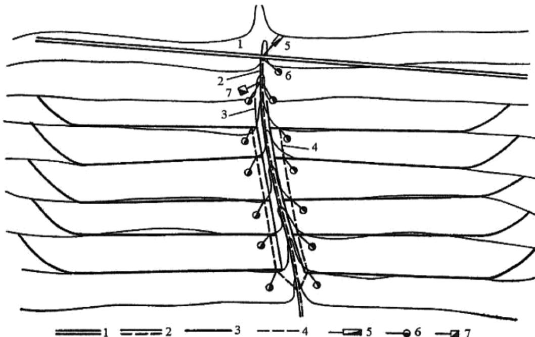
1 - магистральный канал оросительно-обводнительной системы; 2 - сбросной тракт; 3 - земляной вал; 4 - распределительный канал; 5 - ливнепровод; 6 - водовыпускное сооружение; 7 - подпорное сооружение
