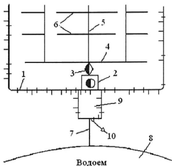
1 - оградительная дамба; 2 - насосная станция; 3 - регулирующий бассейн; 4 - магистральный канал; 5 - водопроводящий канал; 6 - осушители; 7 - водосбросный канал; 8 - водоприемник; 9 - отстойник; 10 - водовыпуск
