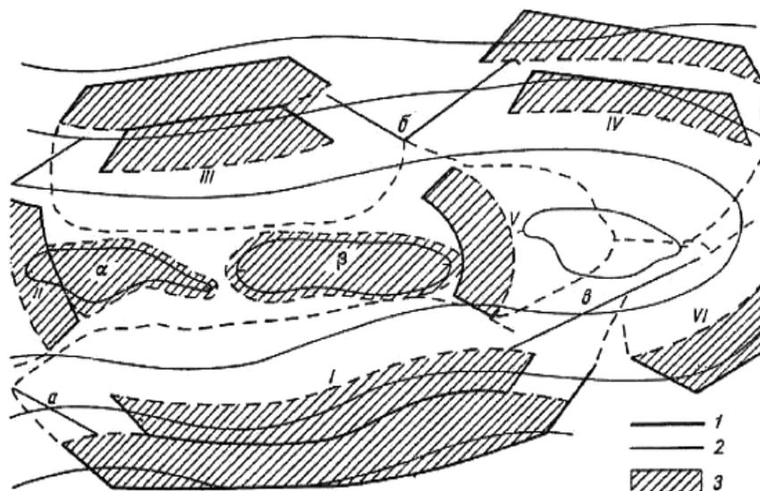
1 - земляные водоудерживающие вали; 2 - водоперехватывающие и направляющие валики; 3 - площади лиманного орошения; прерывистые линии - границы затопления; I-VI - секции лиманов; α, β - замкнутые естественные понижения; а, б, в - перехватывающие и водонаправляющие валики
