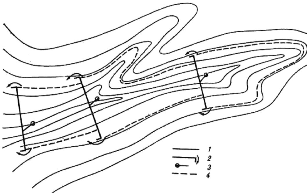
1 - вододерживающие валы; 2 - водообходы; 3 - сооружения, предназначенные для опорожнения ярусов глубокого затопления; 4 - границы затопления
