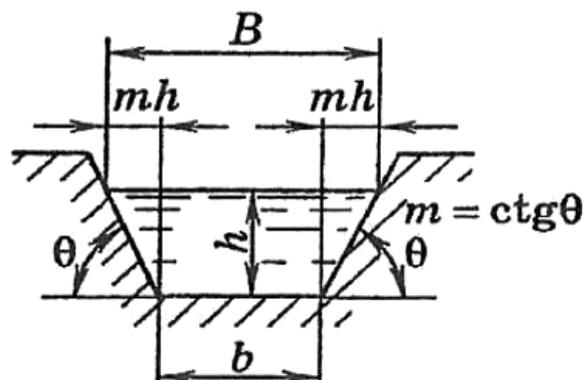
$B$  - ширина по верху,  $b$  - ширина канала по дну,  $h$  - глубина воды в канале,  $m$  - коэффициент заложения откоса ( $m = \text{ctg} \theta$ ,  $\theta$  - угол наклона откоса)
