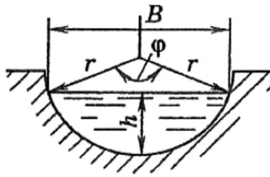
$B$  - ширина поверху,  $h$  - глубина воды в канале,  $r$  - радиус живого сечения,  $\varphi$  - центральный угол сечения
