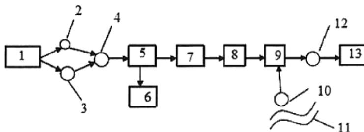
1 - животноводческое предприятие; 2 - навозоприемник (приемный резервуар); 3 - аварийный резервуар; 4 - промежуточная насосная станция; 5 - цех разделения; 6 - площадка хранения твердой фракции; 7 - карантинный резервуар; 8 - секционный накопитель; 9 - узел смешивания стоков с водой; 10 - насосная станция; 11 - водный объект; 12 - мелиоративная насосная станция; 13 - поля орошения [18]
