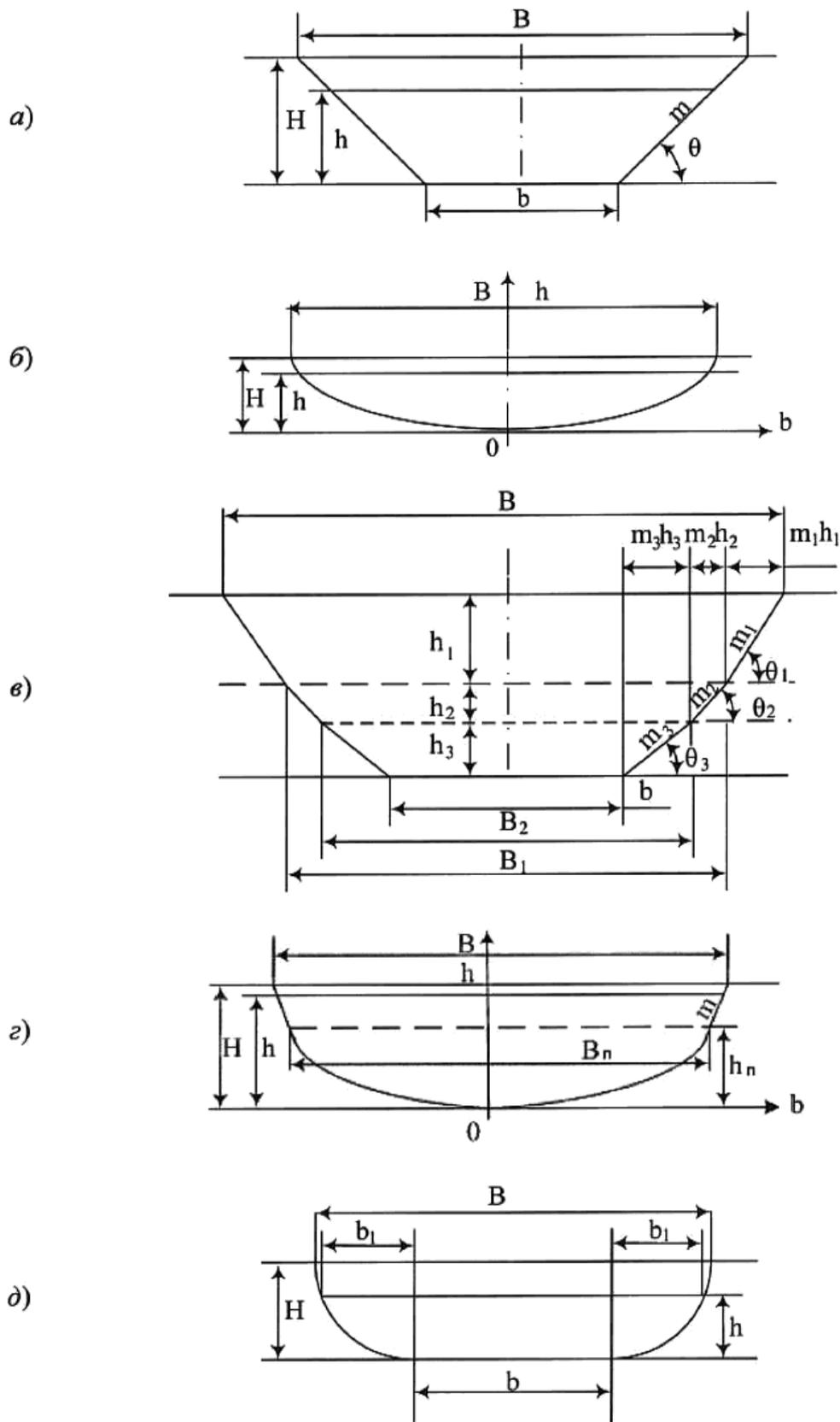
*a* - трапецидальная; *б* - параболическая; *в* - полигональная; *г* - комбинированная; *д* - параболическая с донной вставкой
